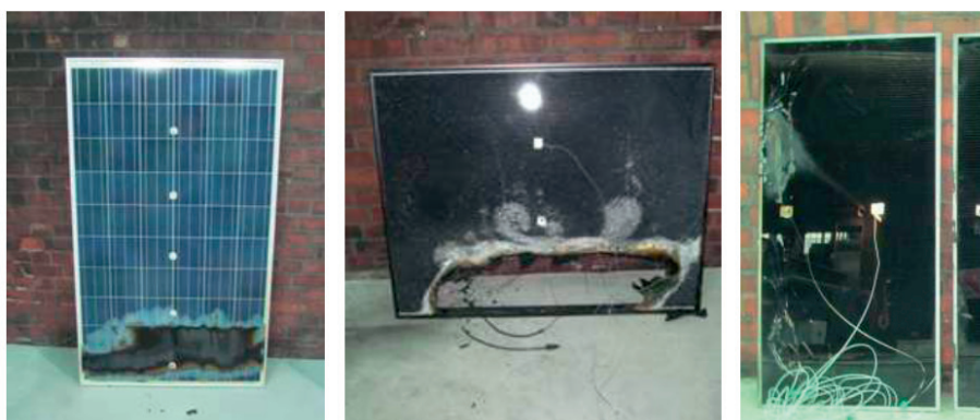
Bild 3-2: Beschädigungen nach Beanspruchung mit 25 kW Brennerleistung, links: c-Si, Mitte: CIS (quer angeordnet), Rechts: CdTe (quer angeordnet)
